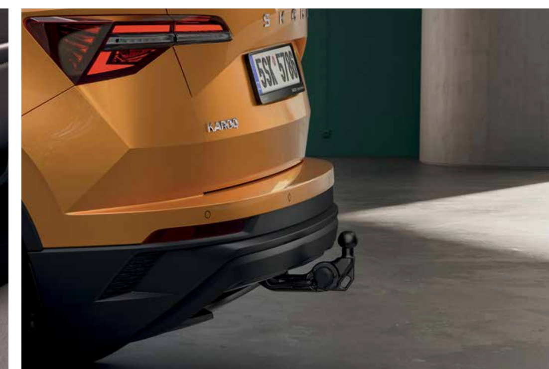
Tažné zařízení sklopné, elektricky odjistitelné
