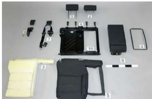
Demontážní studie - příklad demontáže předních dveří a opěry sedačky zadní vozu nové Octavia
