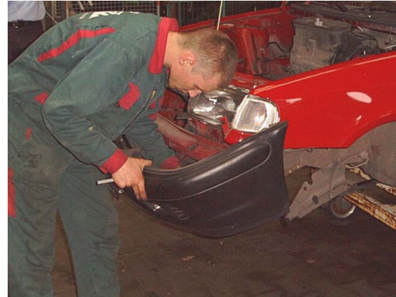
Demontáž plastového nárazníku
